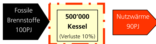
Fig. 5: Energiefluss fossil betriebener Kessel
